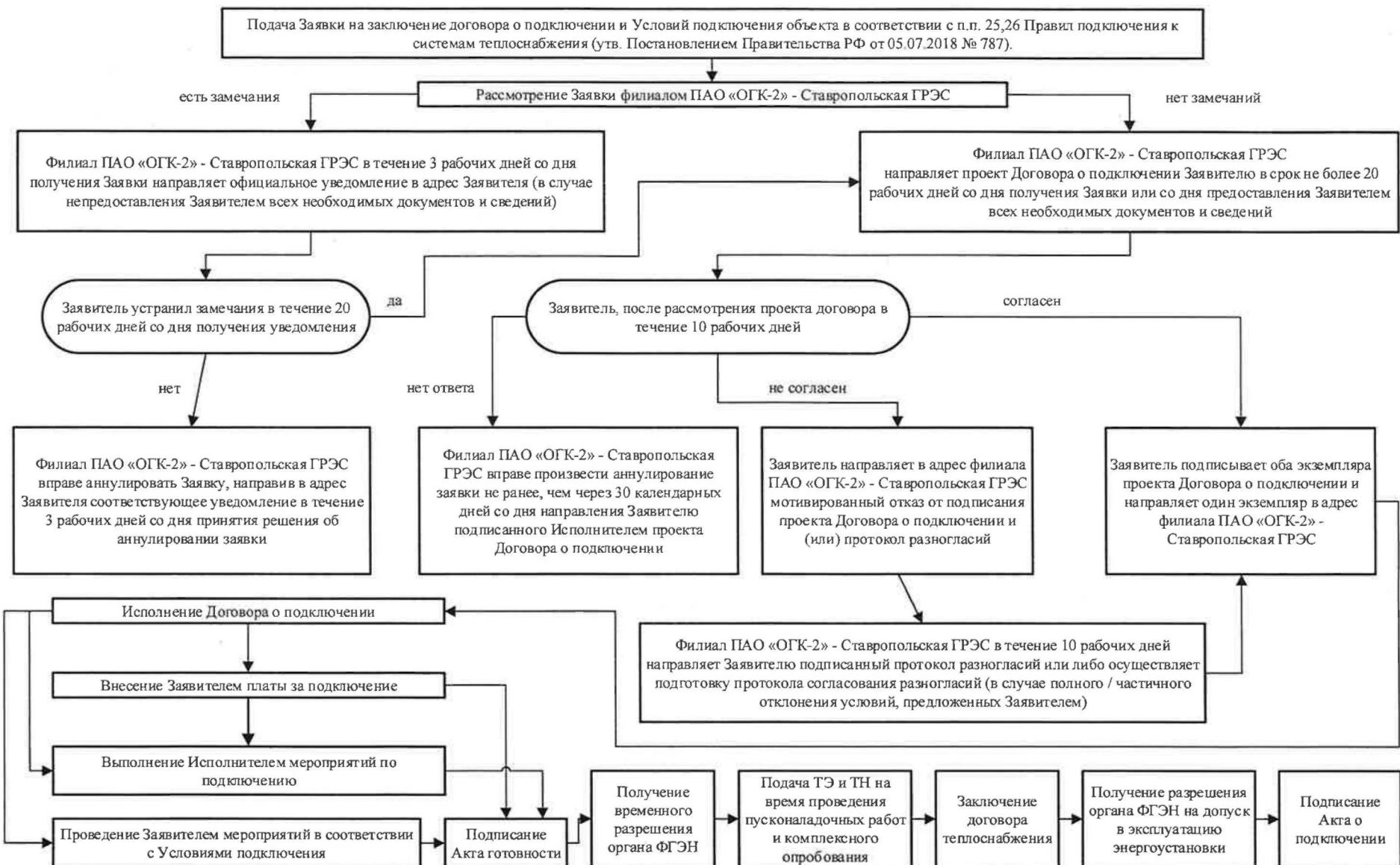
7. Блок схема, отображающая последовательность действий, осуществляемых при подключении к системе теплоснабжения филиала ПАО «ОГК-2» - Ставропольская ГРЭС через тепловые сети или источники тепловой энергии, принадлежащие смежной организации
