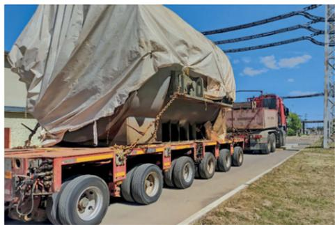
Дополнительных технических решений потребовала от специалистов Киришской ГРЭС операция по перемещению ранее демонтированного статора генератора весом в 79 тонн с площадки временного хранения котлотурбинного цеха № 1 на склад.
