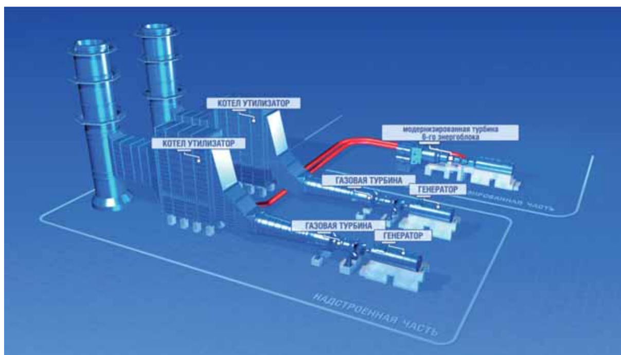
Рис. 2. Схема работы парогазовой установки ПГУ-800 Киришской ГРЭС
